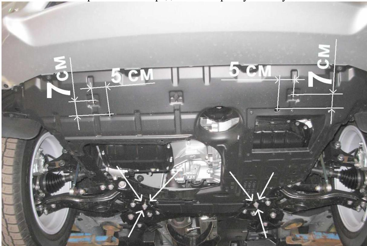
2 болта, обозначенных на фото стрелками, вывернуть на 5-7 мм. для установки задних пластин M10 L100 (поз.1,3). После установки задних пластин болты не обтягивать.
