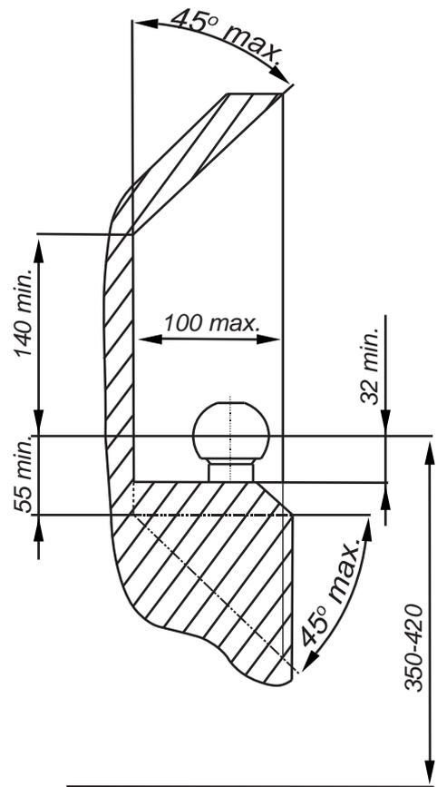
**PL** Należy zagwarantować przestrzeń swobodną według załącznika VII, rysunek 25a/b Regulaminu EKG ONZ 55.01 przy dopuszczalnym ciężarze całkowitym pojazdu.
