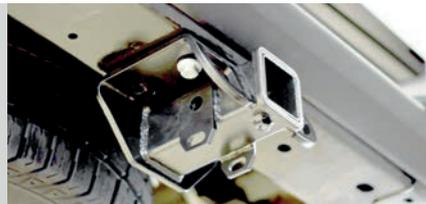
**ШАГ 3.** Установите кронштейн розетки закрепив его четвёртым болтом М12х45х1,25 через шайбу гроверную М12 и шайбу М12.
