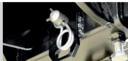
**ШАГ 5.** Затяните шар с помощью ключа на 32 мм. Вкрутите стопорный винт М10х20 снизу. Установка завершена.
