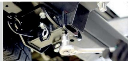
Тип соединения: шаровый; Диаметр сцепного шара: 50 мм.; Масса комплекта ТСУ 20011501: 7,3 кг.
