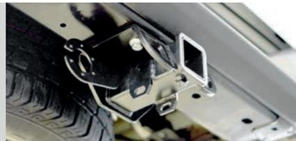
**ШАГ 4.** Установите съемный шар в сборе и зафиксируйте его с помощью пальца гнutoго гальванизированного и шплинта пружинного.
