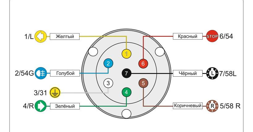
После монтажа проведите проверку правильности присоединения электропроводки тестером с нагрузкой или лампами соответствующей мощности.
